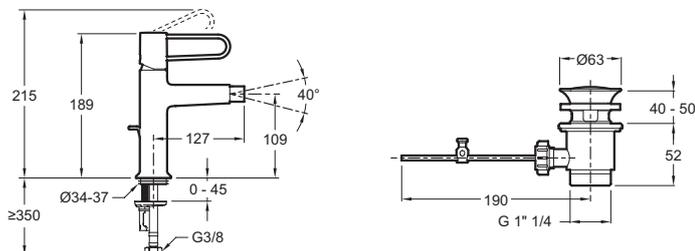
Спецификация продукта : Смеситель для биде с донным клапаном. E21033-BL. Коллекция : ODEON RIVE GAUCHE. ВЕС : 1.3 кг. МАТЕРИАЛ : N/A. ТИП УСТАНОВКИ : 1 отверстие. ТИП : Однорычажный. РАСХОД ВОДЫ : 5 л/мин. ВЫСОТА ПОД ИЗЛИВОМ : 189. РАССТОЯНИЕ МЕЖДУ ЦЕНТРОМ ИЗЛИВА И ЦЕНТРАЛЬНОЙ ОСЬЮ КОРПУСА : 127. ПОДКЛЮЧЕНИЕ : С гибкой подводкой.
